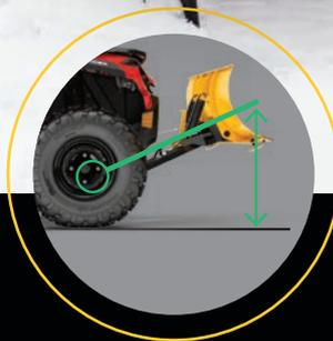
Переднее размещение рамы обеспечивает максимальную высоту подъема.
