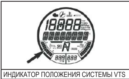
ИНДИКАТОР ПОЛОЖЕНИЯ СИСТЕМЫ VTS
