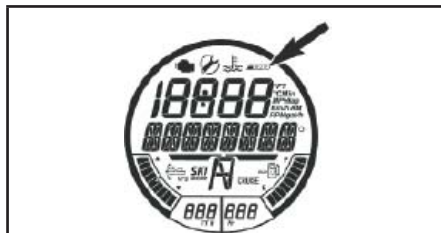
ИНДИКАТОР НЕИСПРАВНОСТИ СИСТЕМЫ iBR
