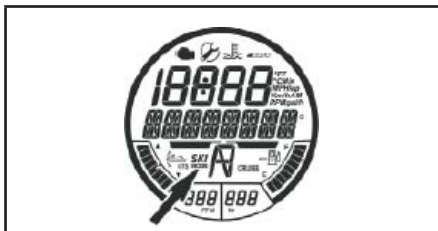
ИНДИКАТОР РЕЖИМА БУКСИРОВКИ ВОДНОЛЫЖНИКА
