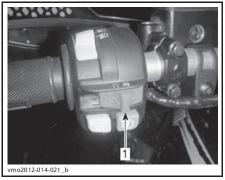
ТИПОВОЙ ВАРИАНТ 1. Выключатель двигателя
