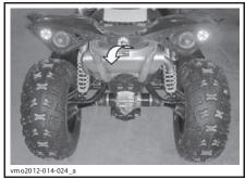
ТИПОВОЙ ВАРИАНТ — МЕСТО КРЕПЛЕНИЯ ЗАДНЕЙ ЧАСТИ МОТОВЕЗДЕХОДА
