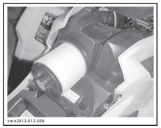
СНЯТИЕ ВОЗДУШНОГО ФИЛЬТРА
