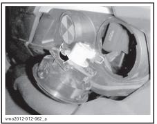
ПОВЕРНИТЕ ЛАМПУ ПРОТИВ ЧАСОВОЙ СТРЕЛКИ
