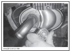
ТИПОВОЙ ВАРИАНТ — СНИМИТЕ ВЫХЛОПНУЮ TPYSY
