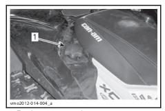
1. Пробка топливного бака
