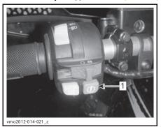
ТИПОВОЙ ВАРИАНТ 1. Кнопка запуска двигателя
