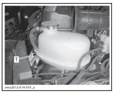
1. Расширительный бачок системы охлаждения двигателя
