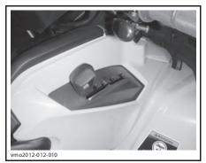
РАСПОЛОЖЕНИЕ РЫЧАГА ПЕРЕКЛЮЧЕНИЯ ПЕРЕДАЧ
