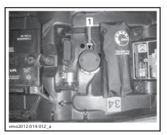
1. Бачок для тормозной жидкости заднего тормоза
