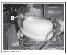
Крышка расширительного бачка системы охлаждения двигателя
