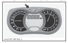
Для сброса показаний установите счётчик пробега за поездку в режим TRIP В, как подробно описано в параграфе «СЧЁТЧИК ПРОБЕГА ЗА ПОЕЗДКУ «А» ИЛИ «В».
