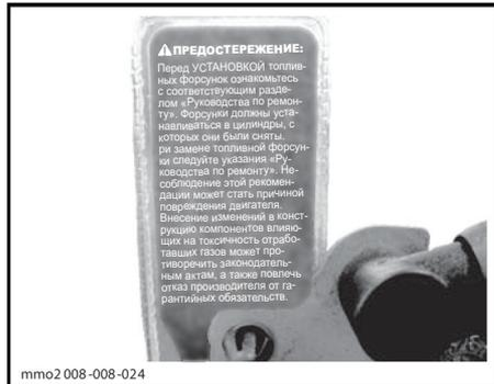
НА ТОПЛИВНЫХ ФОРСУНКАХ — МОДЕЛИ С ДВИГАТЕЛЕМ E-TEC
