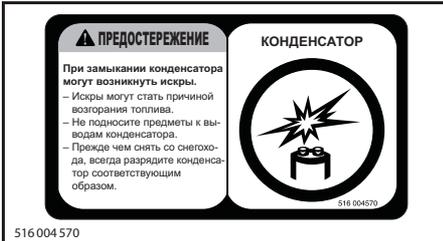
ТАБЛИЧКА 13 — МОДЕЛИ С ДВИГАТЕЛЕМ E-TEC
