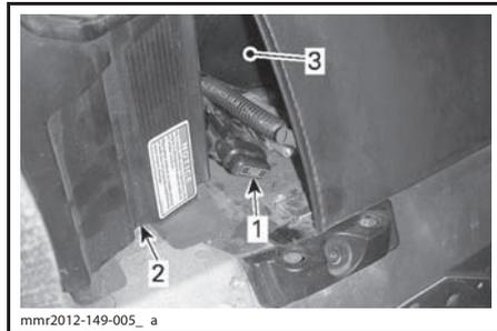
1. Предохранитель системы заряда (20 А)
