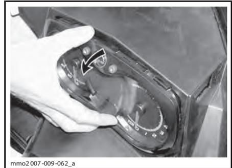
3. Отсоедините разъем перегоревшей лампы. Снимите резиновый чехол.
