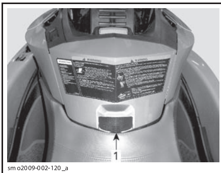
ТИПОВОЙ ВАРИАНТ – ПЕРЧАТОЧНЫЙ ЯЩИК 1. Защелка крышки
