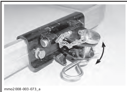
ПРИ БУКСИРОВКЕ СЦЕПНОЕ УСТРОЙСТВО ДОЛЖНО ПЕРЕМЕЩАТЬСЯ СВОБОДНО
