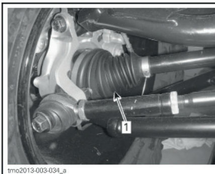
ЗАДНЯЯ ЧАСТЬ МОТОВЕЗДЕХОДА 1. Пыльник наружного шарнира приводного вала
