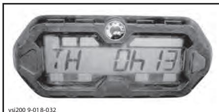
Для сброса показаний счётчика моточасов нажмите и удерживайте в течение 2 секунд кнопку выбора режима индикации.
