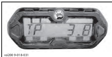
Счётчик можно использовать для оценки расхода топлива или для определения расстояния между двумя точками на маршруте.
