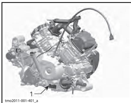
ТИПОВОЙ ВАРИАНТ — ТАБЛИЧКА С СЕРИЙНЫМ НОМЕРОМ ДВИГАТЕЛЯ
