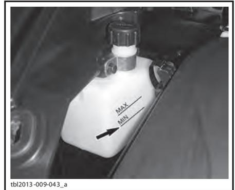
**РАСШИРИТЕЛЬНЫЙ БАЧОК СИСТЕМЫ ОХЛАЖДЕНИЯ**
