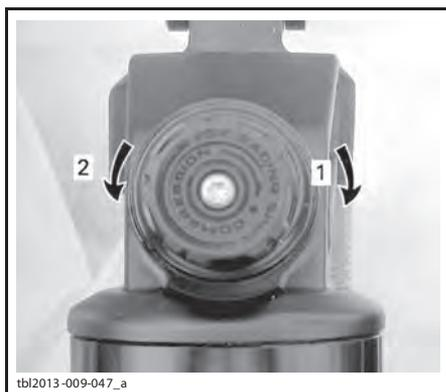
ПОВОРАЧИВАЙТЕ РЕГУЛИРОВОЧНЫЙ ЭЛЕМЕНТ ДЛЯ ВЫПОЛНЕНИЯ РЕГУЛИРОВОК
