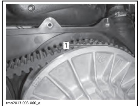
1. Нижние поверхности зубьев вровень с наружной поверхностью ремня вариатора
