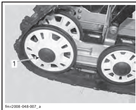
1. Колпачок правого заднего направляющего катка
