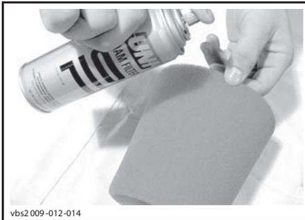
ТИПОВОЙ ВАРИАНТ — НАНЕСЕНИЕ МАСЛА
