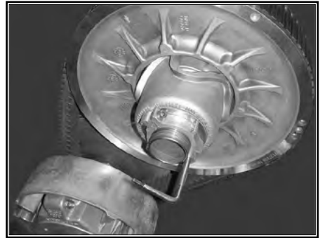
ПРИСПОСОБЛЕНИЕ ДЛЯ РАЗВЕДЕНИЯ ШКИВА В РЕГУЛИРОВОЧНОЙ МУФТЕ
