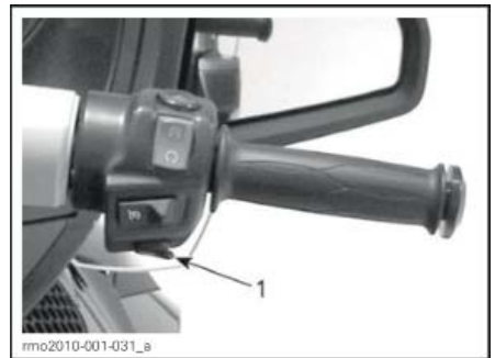
1. Кнопка запуска двигателя
