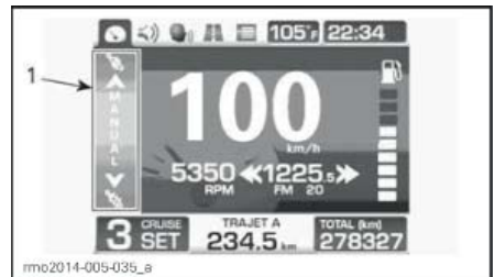
ТИПОВОЙ ВАРИАНТ – ЦИФРОВОЙ ДИСПЛЕЙ В РЕЖИМЕ РУЧНОЙ РЕГУЛИРОВКИ ПОДВЕСКИ 1. Индикация режима ручной регулировки подвески
