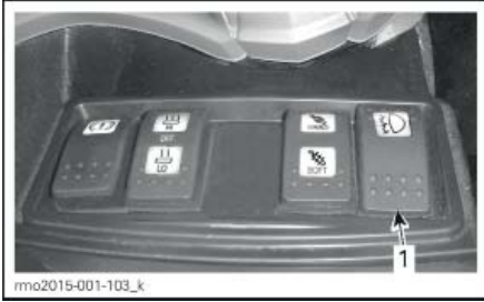
1. Выключатель противотуманных фар
