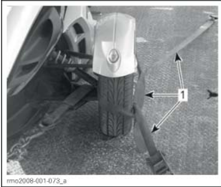
ТИПОВОЙ ВАРИАНТ – ЗАКРЕПЛЕНИЕ ПЕРЕДНИХ КОЛЕС – СПОСОБ 2 1. Ремни вокруг каждого колеса закреплены в передней и задней части прицепа/платформы
