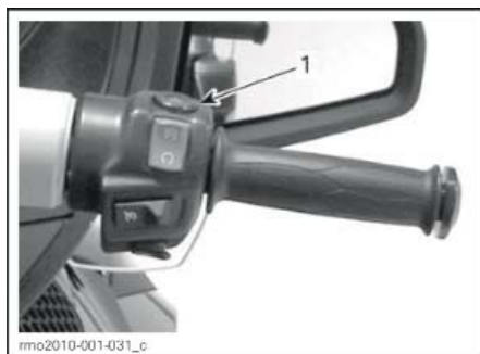
1. Кнопка включения аварийной сигнализации
