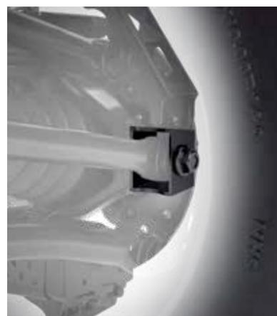
**LONESTAR RACING QUICK RELEASE CLUTCH COVER PINS**
