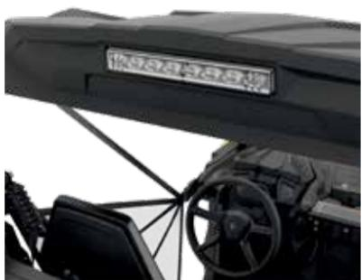
**LONESTAR RACING MOUNTS FOR 39" (99 CM) DOUBLE STACKED LED LIGHT BAR**
