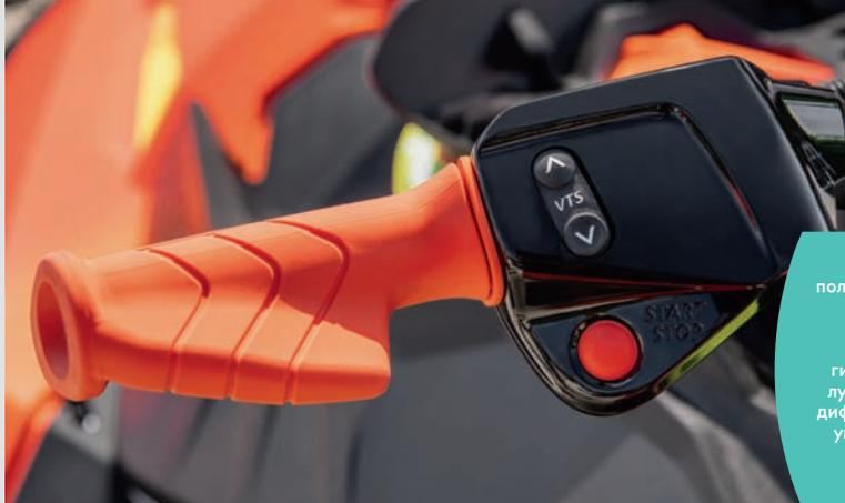
Имеет несколько предустановленных положений корпуса гидроцикла относительно поверхности воды при регулировке дифферента. При увеличении дифферента на корму нос гидроцикла поднимается — такая настройка лучше подходит для буксировки. Увеличивая дифферент на нос, вы получаете возможность управлять гидроциклом в более энергичной манере, а днище судна имеет большую площадь соприкосновения с водой.
